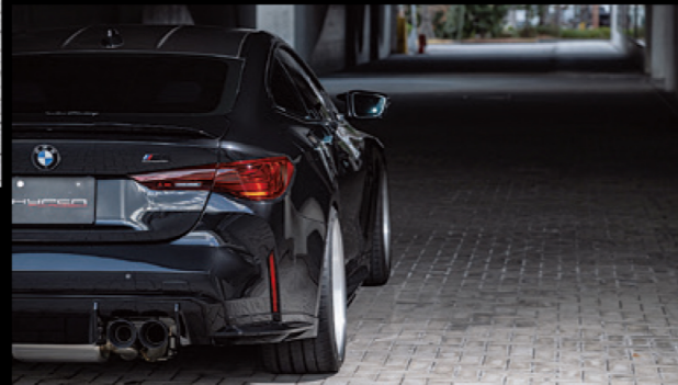
ウィンスファクトリーの小田勝志氏が普段乗っているこのM4コンペティションは、本文で触れたLMCのほか、ワンオフのエキゾーストシステムが装着され、灯火類はM4 CSL用に置き換えられている。ボディ側を黒く落としつつホイールのブラッシュドを強調させる塩梅がいい。
