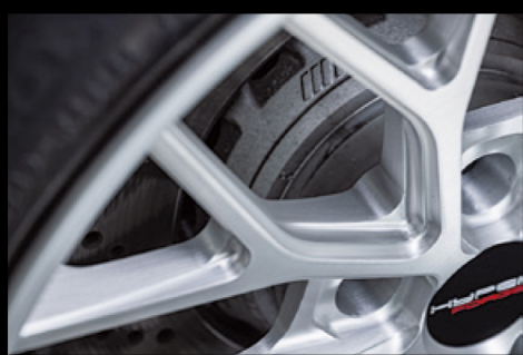
10本ツインスポークで構成されるメッシュパターンは応力分散の点から強度や剛性の確保にも理に適っている。スポークサイドにはエッジの効かせた切削加工が施される。19～22インチ、さらに24インチまで用意され、スポーツからSUVにまで対応する。
