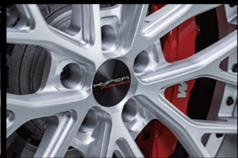
10本ツインスポークで構成されるメッシュパターンは応力分散の点から強度や剛性の確保にも理に適っている。スポークサイドにはエッジの効かせた切削加工が施される。19～22インチ、さらに24インチまで用意され、スポーツからSUVにまで対応する。
