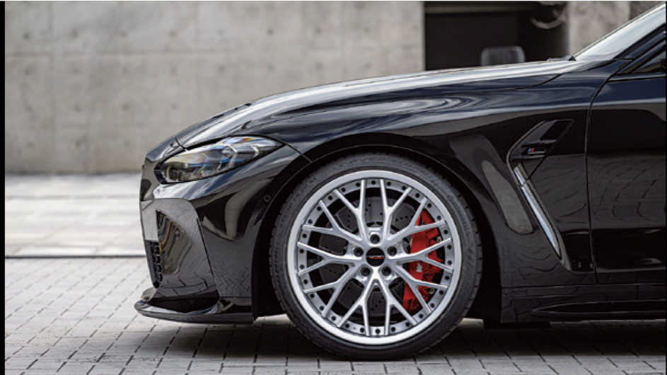
10本ツインスポークで構成されるメッシュパターンは応力分散の点から強度や剛性の確保にも理に適っている。スポークサイドにはエッジの効かせた切削加工が施される。19～22インチ、さらに24インチまで用意され、スポーツからSUVにまで対応する。
