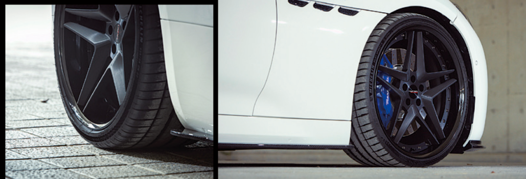
5つのツインスポークで星型デザインを構築する。センターパートを覆うように置かれるスポークの接合部は立体的で、角度によって様々な表情をみせる。これはブラッシュドブラックディスク、グロスブラックリムを12個のクラシカルピアスボルトで繋ぎ止めている。タイヤは①275/25ZR21、②335/25ZR22の前後異型サイズで、銘柄はミシュラン・パイロットスポーツ4Sだった。
